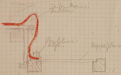
EPDM um Seitentorsatz holen und mit 'Abdichtungshölzchen' auf alle Wände befestigt.
